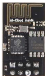
Fig. 4: ESP8266-01 Wi-Fi Module
